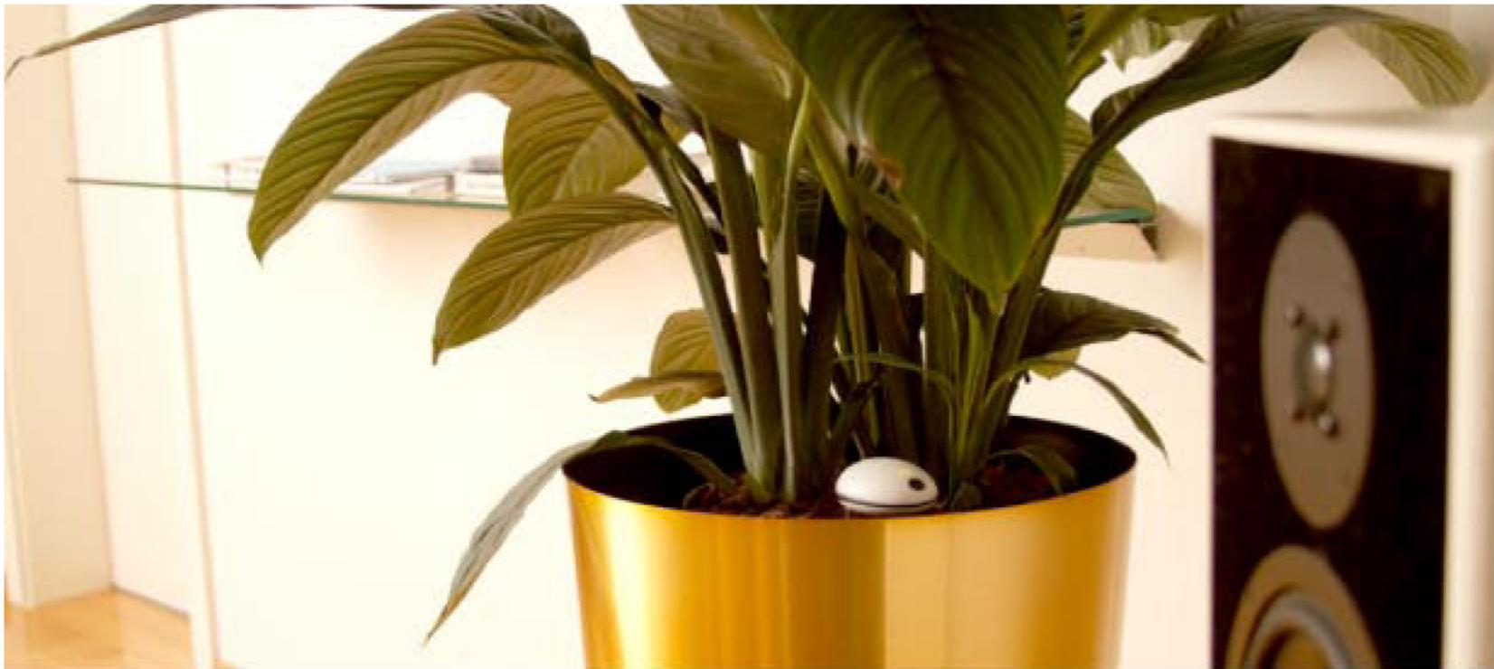
Der Sensor ist mit einer Spitze ausgestattet, die tief in den Topf gesteckt wird
